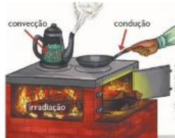
Representação dos processos de transferência do calor em um forno a lenha
